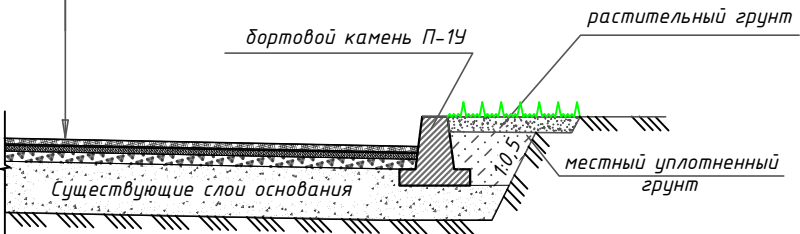
КРЕПЛЕНИЕ БОРТОВЫХ КАМНЕЙ НА СТЫКАХ
